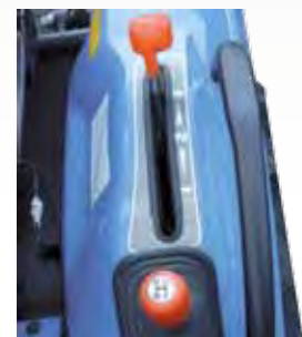
LEVIER DE VITESSE ERGONOMIQUE Type automobile et sélecteur de gamme à portée de main
